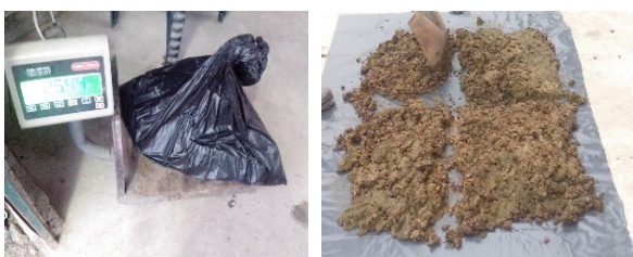
Figura 2. Pesaje de las excretas de vaca y aplicación del método de cuarteo.
